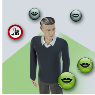
Figure 5 – Les microphones directionnels traditionnels amplifient tous les sons situés dans le faisceau, y compris les bruits indésirables. UltraZoom avec RS/B-Plus élimine efficacement le bruit, améliorant le RSB pour les signaux vocaux frontaux.
